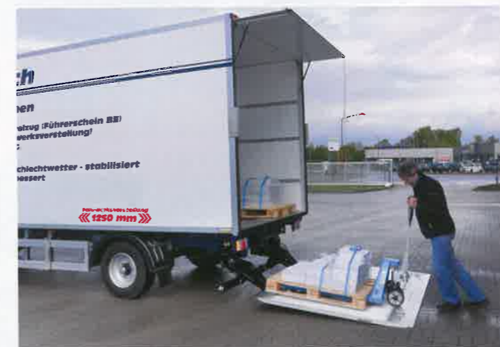
Die Sörensen X1-Ladebordwand hat eine Tragkraft von 750 Kilogramm bei einem geringen Eigengewicht
