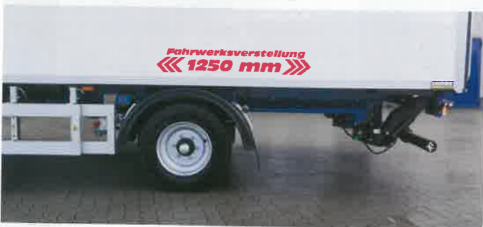
Die Achse lässt sich um 1,25 Meter verschieben, der Unterfahrschutz verkürzt oder verlängert sich automatisch mit
