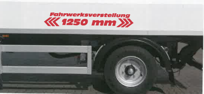
Die Achse lässt sich um 1,25 Meter verschieben, der Unterfahrschutz verkürzt oder verlängert sich automatisch mit
