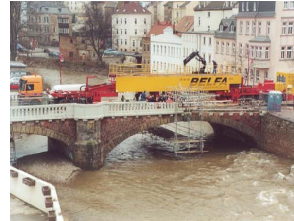
BELFA Brückenbelastungsfahrzeug mit mehr als 100 t Gesamtgewicht
