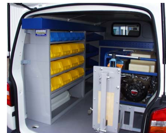
Fahrzeugeinrichtungen kombiniert mit Sondereinbauten und Stromversorgung
