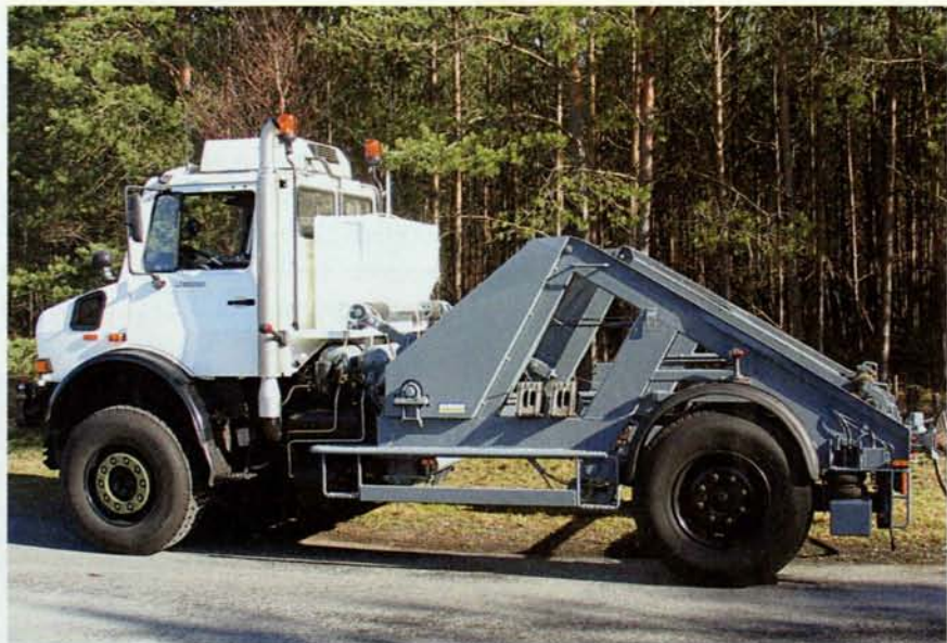
Neue Verbindung von Eggers: Unimog-Triebkopf und Trommelwagen-Anbau
