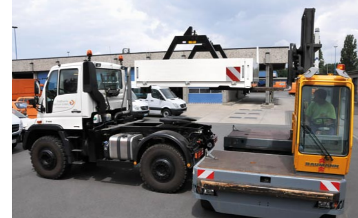
Unimog U 400 als Sattelzugmaschine mit einem Ersatzstromerzeuger (links)
