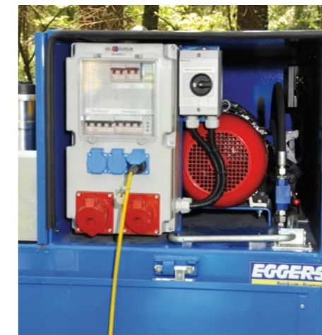
Das Notstromaggregat zur Versorgung der Elektrowerkzeuge wurde von der Aufbaufirma Eggers auf der Pritsche montiert (oben)
