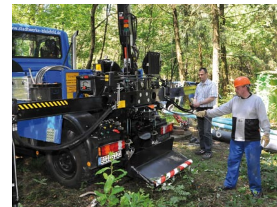
Das Notstromaggregat zur Versorgung der Elektrowerkzeuge wurde von der Aufbaufirma Eggers auf der Pritsche montiert (oben)
